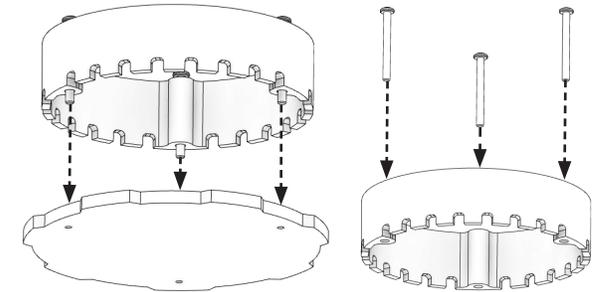
3. Après avoir assemblé toutes les pièces du brûleur, placez-le dans le fond du foyer. Alignez les goujons du brûleur avec les trous du fond du foyer. Tournez le brûleur dans le sens des aiguilles d'une montre pour le verrouiller en position. **REMARQUE : Si un kit de brûleur de rechange (893653) est nécessaire, veuillez appeler le service à la clientèle.**
