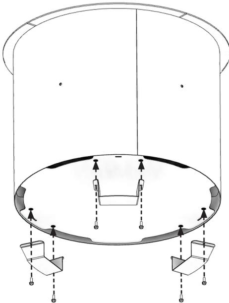
2. Fixez le bas du brûleur au haut du brûleur à l'aide de (3) boulons 1/4-20. Faites glisser chaque boulon à travers le côté inférieur du brûleur inférieur. Les boulons seront ensuite vissés dans la partie supérieure du brûleur. **REMARQUE :** Laissez un petit espace entre la tête du boulon et le brûleur inférieur, de l'épaisseur du fond du foyer (environ 1/16 po à 1/8 po).
